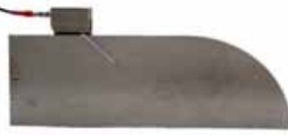
Рис. 2. Индикация выявления отражателя при обычном УЗК
