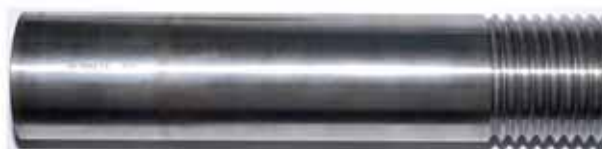
Рис. 3. Стандартный образец типа КО2353.08 для контроля метрической резьбы
