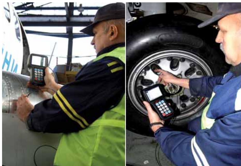
Рис. 1. Контроль зоны заклепок крыла (слева) и вентиляционных окон барабанов колес (справа)
