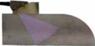
Рис. 3. Индикация выявления отражателей при использовании ФАР
