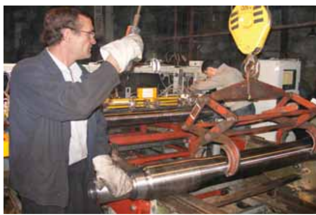
Рис. 3. Загрузка контролируемой оси на пост контроля
