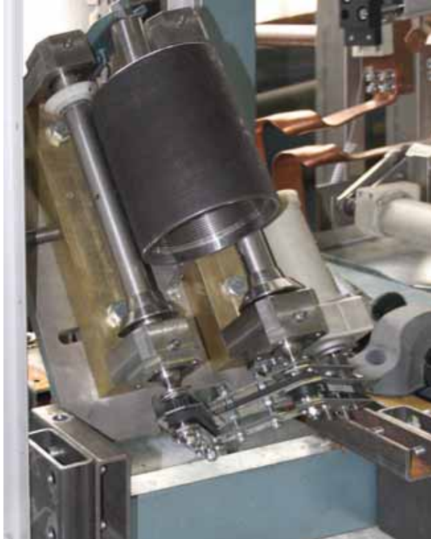
Рис.2 УМПК-4М – пост полива, опрокидывание муфты.
