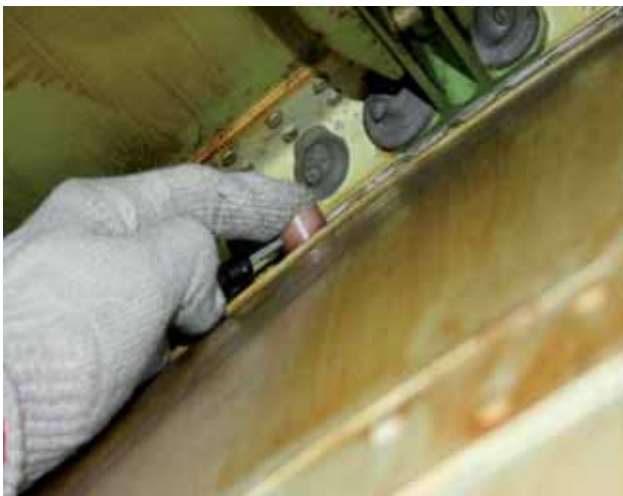
Рис. 6. Установка кольцевого ВТП на заклепку в зоне заднего гермопангоута
