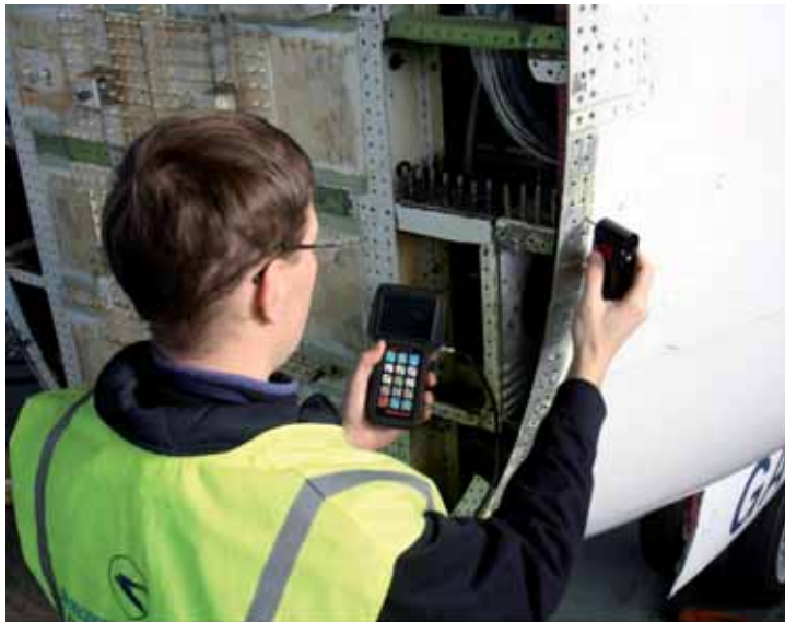
Рис. 4. Выявление дефектов отверстий крепления гермошпангоута с помощью дефектоскопа ВД 3-81 "EDDYCON" и роторного сканера
